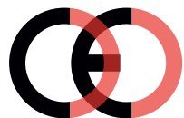
Falsk CE-mærke (for tæt på hinanden)
